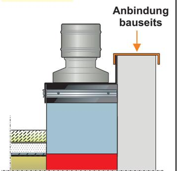
Dampfsperre (rot) gemäß Flachdachrichtlinie bis über Oberkante Dämmung führen.
