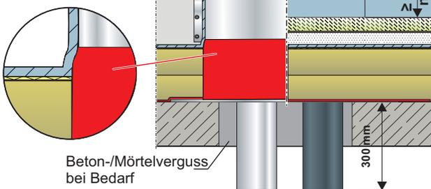
Dampfsperre (rot) gemäß Flachdachrichtlinie bis über Oberkante Dämmung führen.
