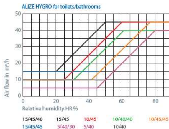
Abbildung 5: Abluftvolumenstrom in Abhängigkeit der relativen Luftfeuchtigkeit
