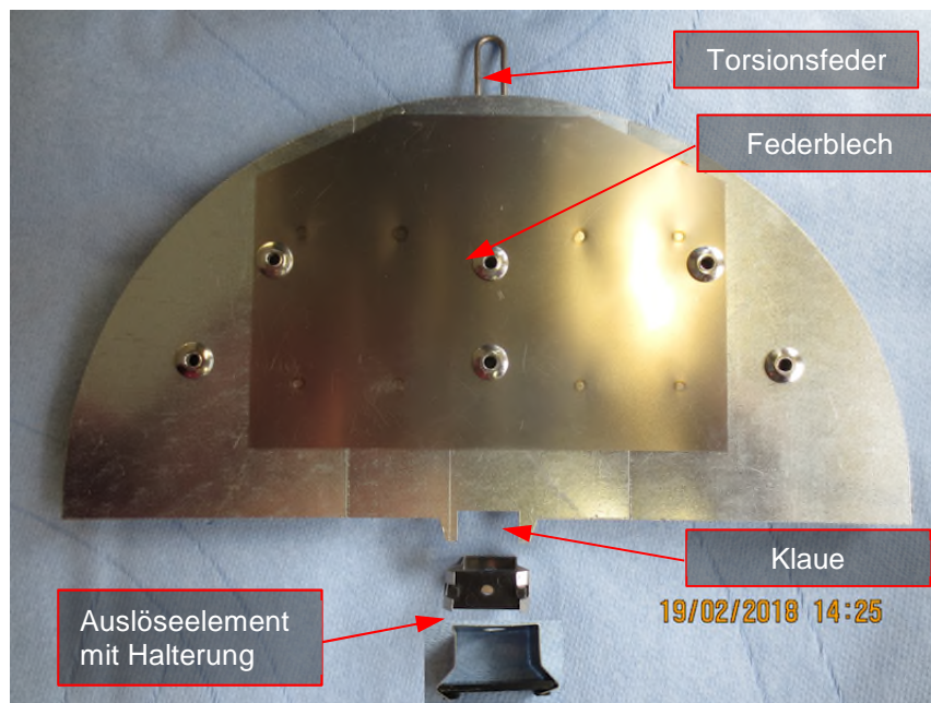
Abbildung 4: Klappenblatt und Auslöseelement nach Demontage
